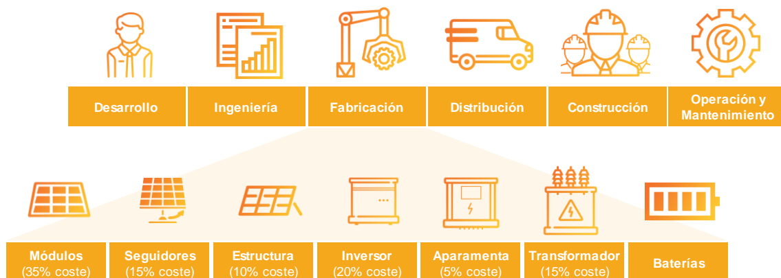
Figura 2. Cadena de valor del sector fotovoltaico. Fuente: Elaboración propia UNEF
